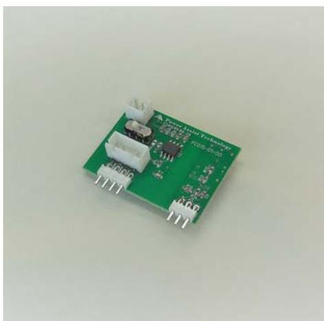
電源装置には欠かせない電圧検出ですが、デジタル制御電源では主回路と制御系の電位が異なり、何らかの形で絶縁が必要となります。
