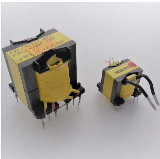
LLC はトランスの漏れインダクタンスを積極的に利用した回路方式ですが、現在広く用いられているセクション巻のボビンを使用したトランスでは、漏れインダクタンスを自由に設定することが困難で、必ずしも共振条件を最適化することができませんでした。
