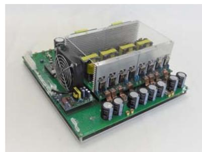
フェイズシフト方式の LLC コンバータで幅広い入力電圧変動に対応した高効率 2kW 電源
