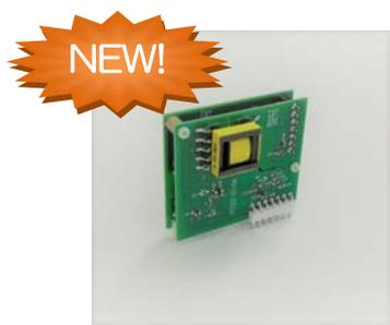
ローム株式会社のゲートドライバ IC **BM6108FV-LB** を 2 個搭載した IGBT、FET 用ゲートドライバーモジュールです。
