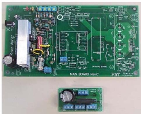
約 100kHz で動作するワイヤレス電力伝送は、LLC 共振電源のトランス 1 次側と 2 次側を離れた場合に相当します。
